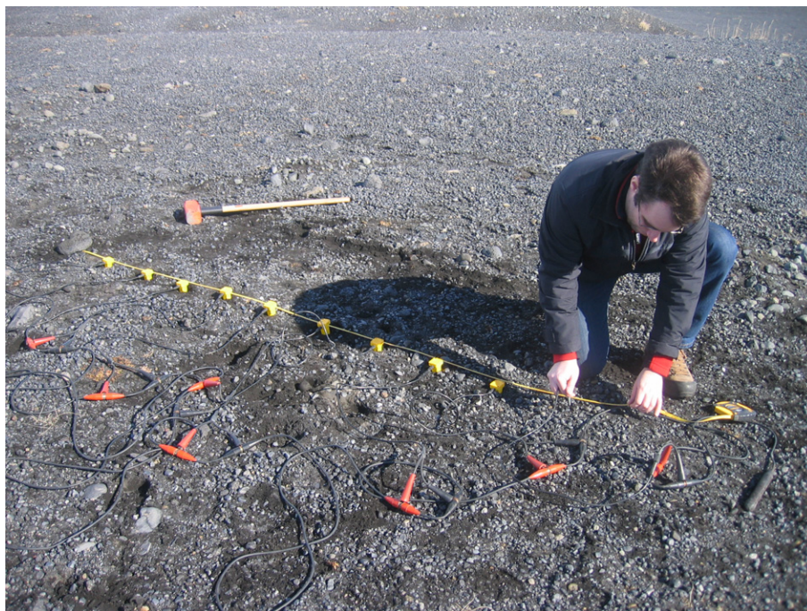
Mynd 4.1: Stuttu mæliferlinum stillt upp við Gígjukvísl í apríl 2007. Í bakgrunninum sést 6 kg sleggjan sem notuð var til þess að framkalla högg. Ljósmynd: Davíð Rósenkrans Hauksson.
